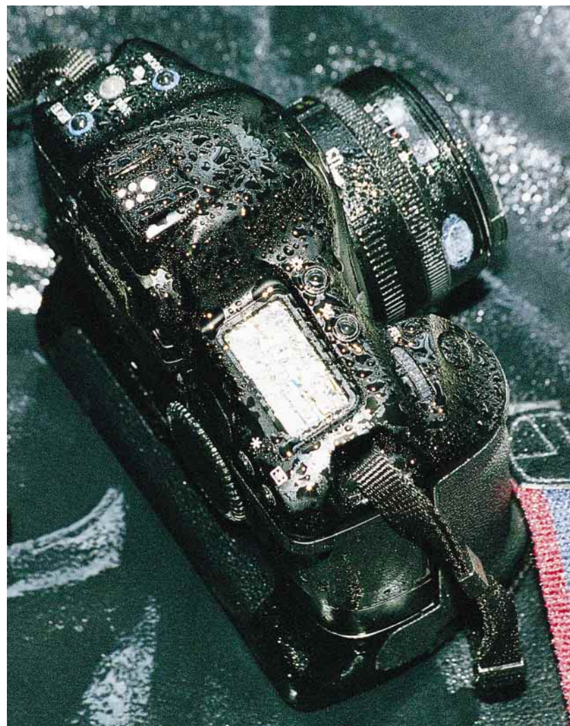
Risba zgoraj: 72 delov, vidnih na skici, na in v kameri je posebej zaščitenih s silikonsko gumo. Slika zgoraj: Na zadnjem delu kamere je lepo vidna silikonska guma, ki preprečuje vstop vlage, vode, prahu in drugih tujih delcev v kamero. Slika levo: Kamero sem dobil zmočil z vodo. Če bi imel na razpolago objektiv, ki je tudi zaščiten s silikonsko gumo, bi jo preizkusil na še bolj moker način.
