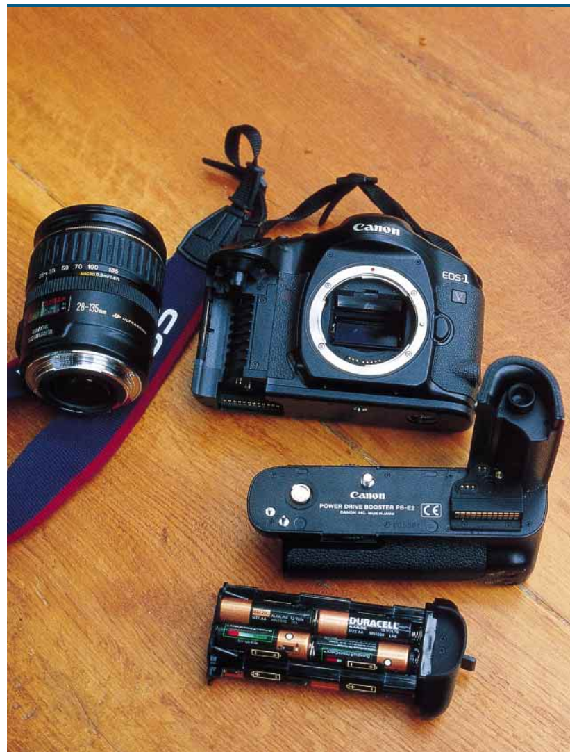
Slika zgoraj: EOS 1v in dodatni motorni pogon. Teža in velikost se predvsem zaradi dodatnih osmih baterij zelo povečata.
