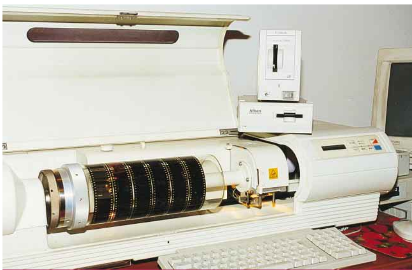
Skenerja na velikem bratu. Bobnasti skener SCREEN DTS-1030A lahko skenira do 42 diapozitivov laica formata hkrati. Kakovost je glede na manjše skenerje veliko boljša. Seveda pa je tudi cena tako zasoljena, da tak skener ni primeren za hobi fotografa.
