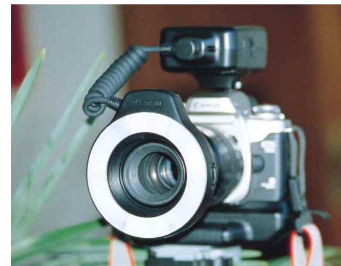
Posebna bliskavica za fotografiranje od blizu nam zares olajša delo. Merjenje svetlobe je TTL (skozi objektiv), zato se za pravilno osvetlitev ni bati. Bliskavica je sestavljena iz dveh bliskovnih cevi (ena je na levi, druga na desni) in lučk za doosvetlitev, ki jih uporabljamo pri nastavitvi ostrine. Levo ali desno bliskovno cev lahko posamično izklopimo, tako da lahko pri nekaterih motivih pridobimo na plastičnosti zaradi močnejših senc.
